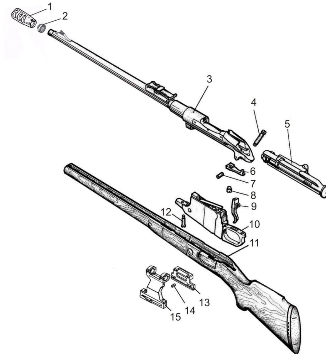
1-тормоз дульный ВПО-220.00.61; 2-гайка ВПО-220.00.62; 3-коробка ствольная со стволом ВПО-220.01.00, -01; 4-винт хвостовой; 5-затвор; 6-спусковая пружина; 7-шпилька хвостового крючка; 8-винт спусковой пружины; 9-спусковой крючок; 10-магазинная коробка с подающим механизмом ВПО-220.04.00; 11-ложа ВПО-220.01.00; 12-винт упора; 13-планка ОП-СКС 30; 14-заклёпка; 15-кронштейн СОК-94 С617.
